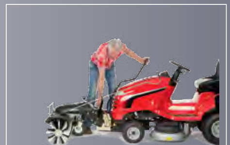
3 sec. Snelsluiting naar onderen drukken. Klaar
