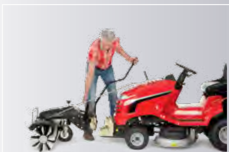
1 sec. Het werktuig voor de zitmaaier plaatsen.
