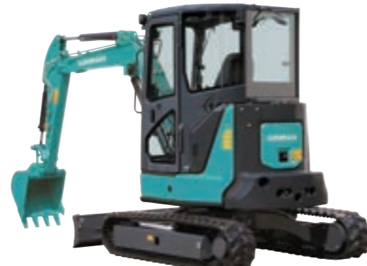
AX38u-7 Operationeel gewicht Vermogen 3.960kg 0,10m 3 Rubberen rupsbanden, cabine
