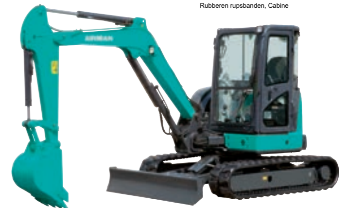
AX55u-7 Operationeel gewicht Vermogen 5.210kg 0,14m 3 Rubberen rupsbanden, Cabine
