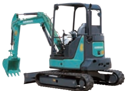
AX33u-7 Operationeel gewicht Vermogen 3.330kg 0,08m 3 Rubberen rupsbanden, Kap op vier steunen
